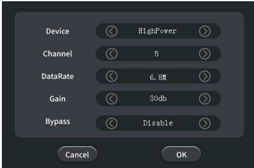
Device : 模块选择 ( HighPower:UWB3000F27、 LowPower:UWB3000F00 )
